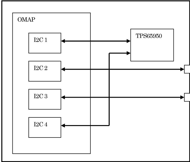
ユーザ用に I2C 2 と I2C 3 が配線されています。モジュール内部では未使用の状態です。SDL, SDA とともにモジュール内で 4.7kΩ で pullup されています。信号のレベルは 1.8V C-MOS レベルになります。3.3V や 5V のラインとは直接接続はできません。なお、I2C 1 および I2C 4 は モジュール内部で使用しており、ユーザ利用はできません。
